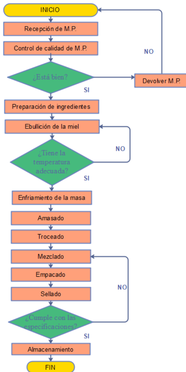
Figura 67. Diagrama de flujo del proceso productivo de la melcocha con frutos secos
