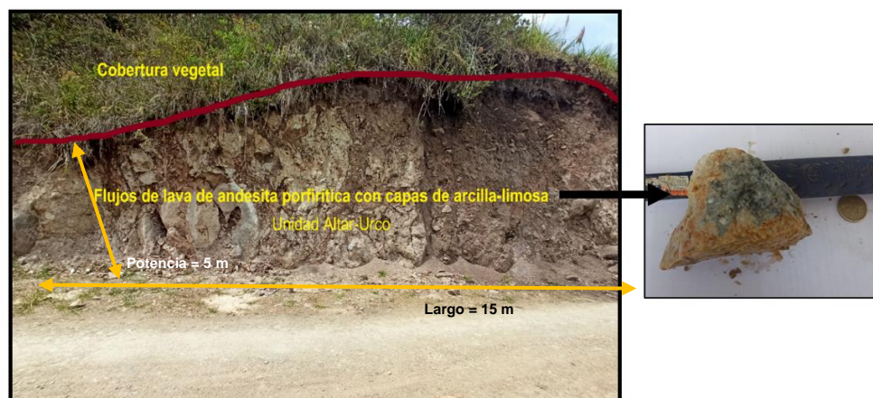
Figura 21. Afloramiento perteneciente a la Unidad Altar Urco por el sector El Chorro Huapuca
