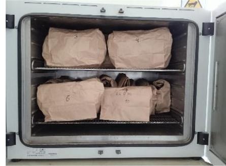
**Figura 20.** Secado de muestras de biomasa en estufa
