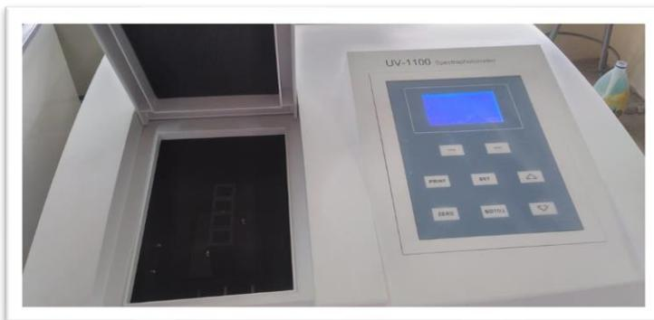
Usó del contenido del vial como si fuera una muestra de suero y lectura de cada muestra en el espectrofotómetro.
