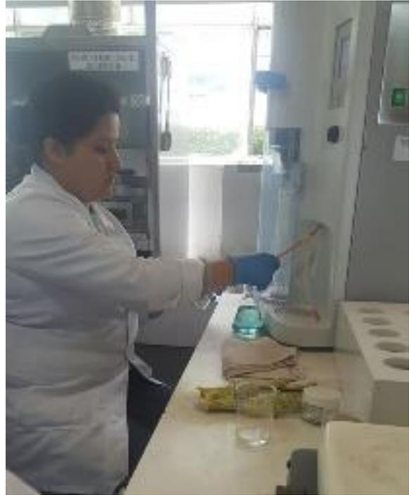
**Figura 39.** Proceso de digestión en el equipo de Kjeldahl.
