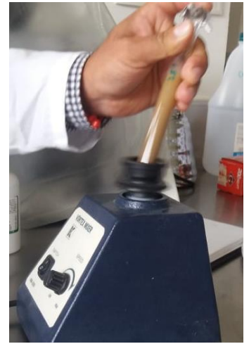
Foto 3: Vortex de la muestra para preparar diluciones seriadas.
