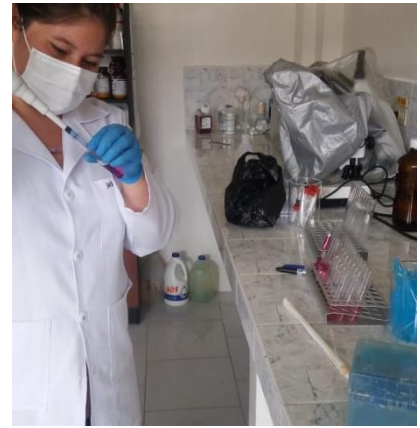
Foto 27: Preparación de la curva de calibración de AIA
