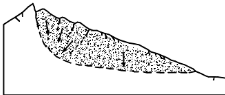
Figura 4: Esquema de Hundimiento. Fuente: Varnes (1978)
