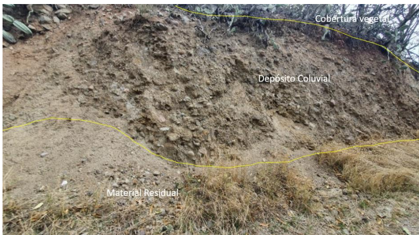
Figura 25: Depósitos coluviales, clastos de rocas intrusivas (granodiorita) en matriz arenosa sector el Tingo
