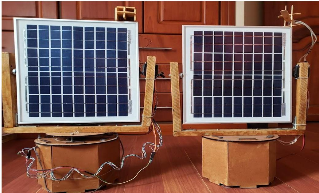
**Figura 35.** Seguidor a un dos ejes y un eje contruidos.
