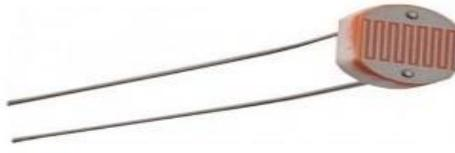
**Figura 12.** Resistencia dependiente de la luz.
