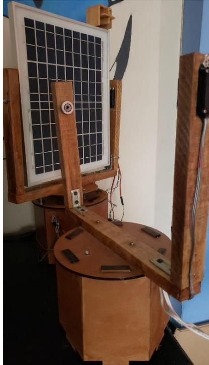
**Figura 23.** Estructuras de seguidores
