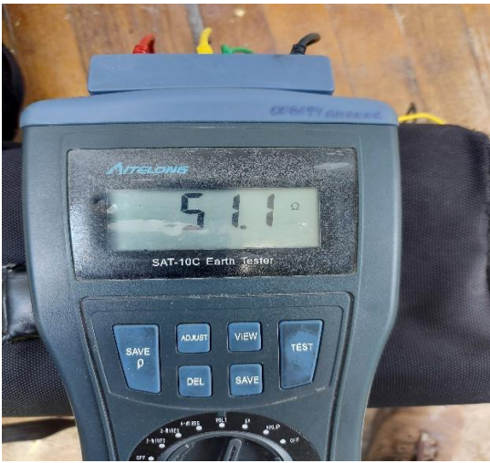
Figura A. 27: Medida de resistividad del sistema de tierra del bloque A9 con 2 metros de separación entre las varillas. Fuente: Compilada por el Autor.
