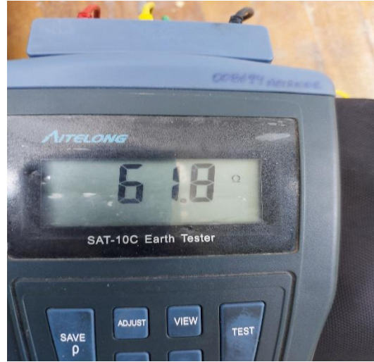
Figura A. 26: Medida de resistividad del sistema de tierra del bloque A9 con 4 metros de separación entre las varillas. Fuente: Compilada por el Autor.
