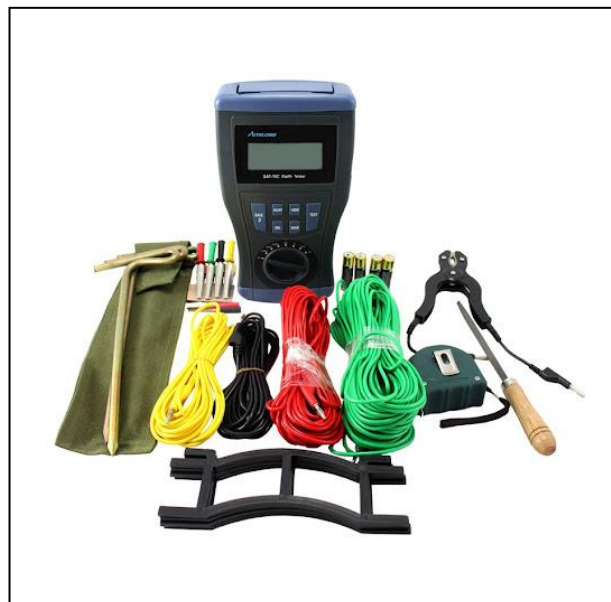
Figura 22. Telurómetro usado en la medición del sistema de puesta a tierra de la FEIRNNR modelo sat-10c earth tester.
