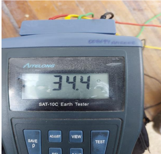
Figura A. 28: Medida de resistividad del sistema de tierra del bloque A9 con 1 metro de separación entre las varillas. Fuente: Compilada por el Autor.
