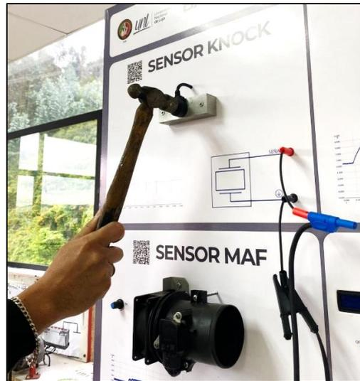
El rango de trabajo del sensor se encuentra entre 200 y 400 mV, al ser una señal demasiado baja, es difícil determinar con exactitud la amplitud. Por lo tanto, se ha visualizado su comportamiento mediante un osciloscopio, tal como se muestra en la Figura 60.
