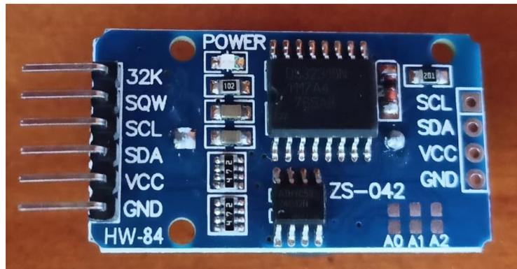
**Figura 35** Reloj de tiempo real electrónico.
