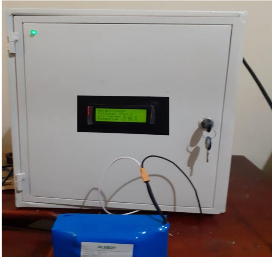
**Figura 44** Prototipo de estación de carga para Bicicletas Eléctricas.
