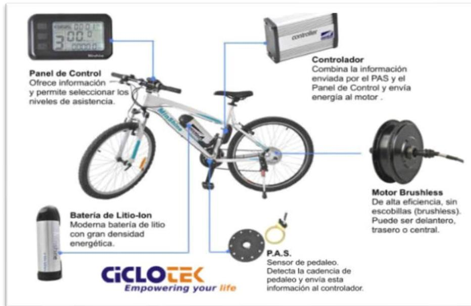
**Figura 1** Partes de una bicicleta eléctrica.
