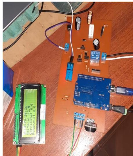
**Figura 42** Impresión de placa y montaje del circuito de control y potencia.
