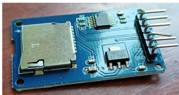
**Figura 36** Módulo de almacenamiento de datos SD.
