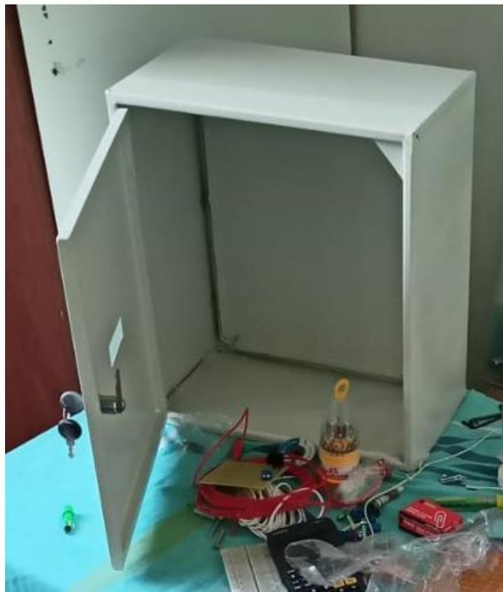
**Figura 39** Caja de chapa metálica para inserción de los componentes electrónicos.
