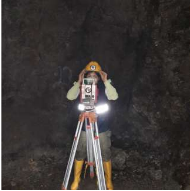
Fotografía 3: Levantamiento topográfico interior mina
