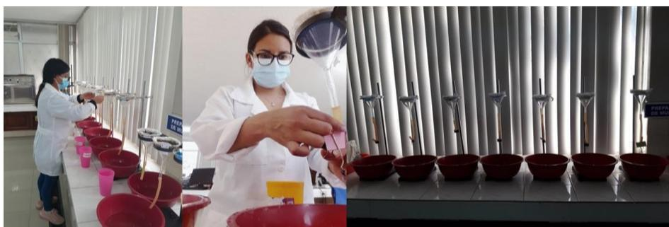
**Figura 20.** Reposo de muestras de suelo mediante el método de embudo de Baerman.
