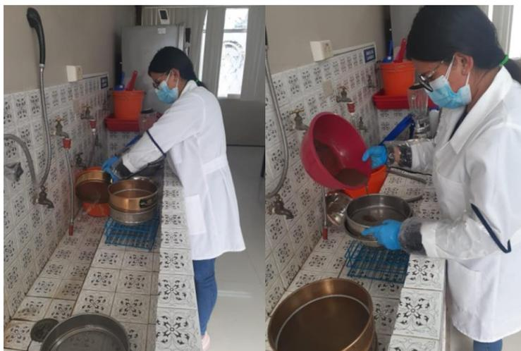
**Figura 19.** Proceso de muestras por el método de método de platos calados Baerman modificado y para suelo el método de Stemerding.
