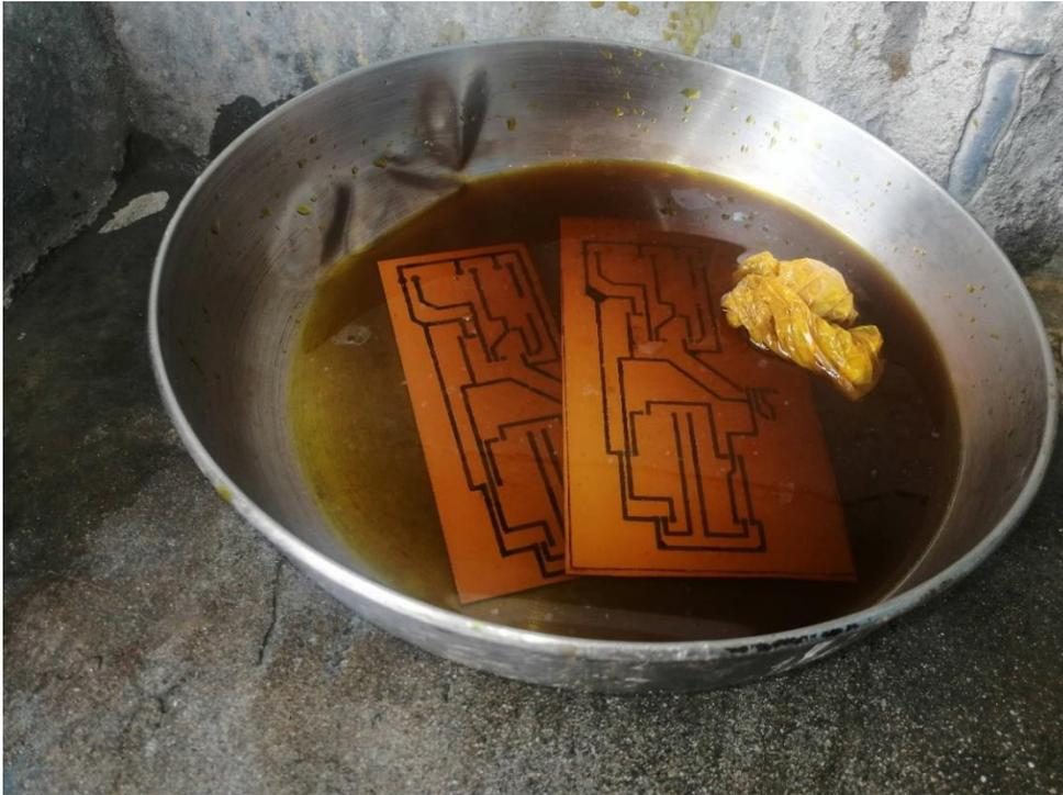
**Figura 88.** Proceso químico para quitar residuos de cobre de la placa PCB.
