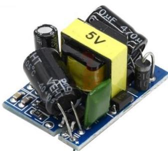
**Figura 37.** Transformador reductor de AC a DC [56].
