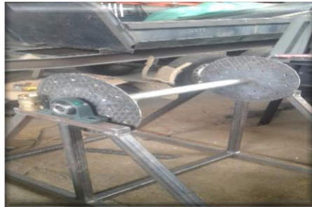
Figura 35. Montaje del eje. Fuente: Propio.
