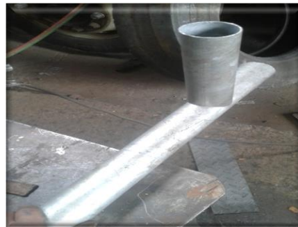
Figura 36: Perforación del eje. Fuente: Propio.
