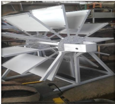
Figura 38: Pintado de la Bomba. Fuente: Propio.
