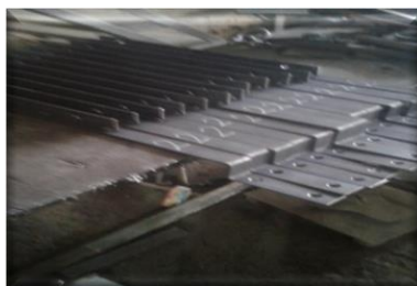
Figura 32: Varilla de soporte de las espirales. Fuente: Propio.
