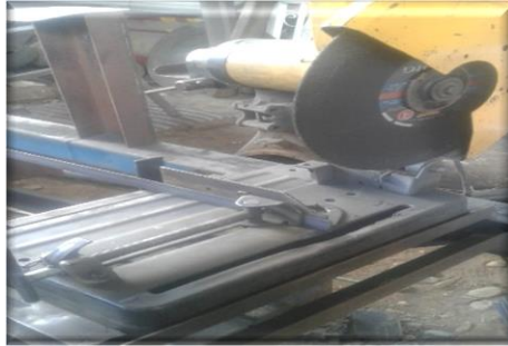
Figura 30: Corte de la platina. Fuente: Propio.
