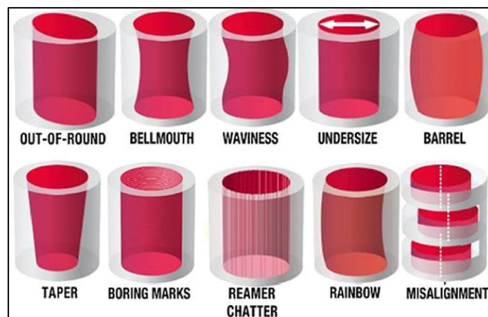
Figura 3. Errores corregidos por el bruñido.
