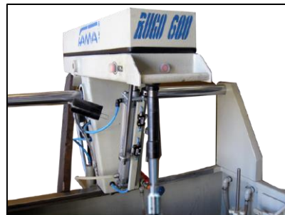
Figura 25: Accionamiento neumático en una bruñidora. Fuente: Fama (s.f.)
