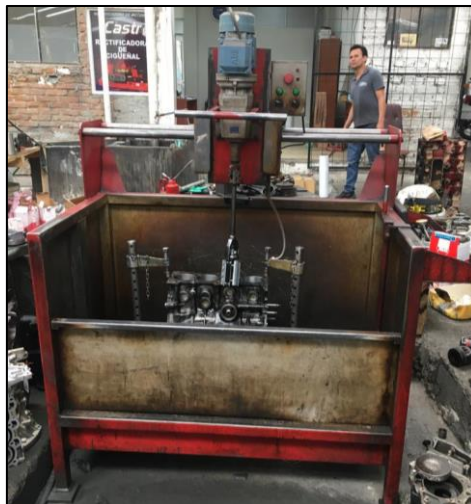
Figura 11: Máquina bruñidora utilizada por la rectificadora Castro.
