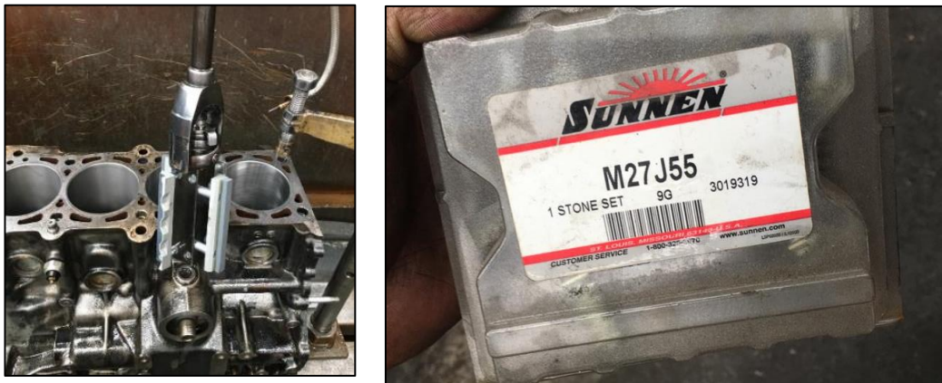
Figura 29: Bruñidor y piedras abrasivas utilizadas en el taller de rectificado Castro.
