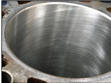
Figura 4: Rayadura del cilindro después del proceso de bruñido. Fuente: Autor.
