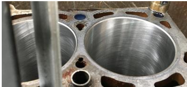
Figura 9: Rayado que forma el ángulo de bruñido. Fuente: Autor.
