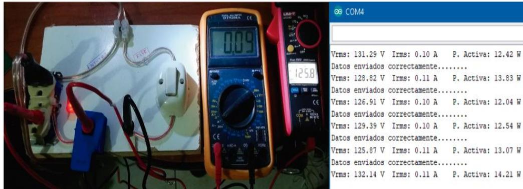
Figura 52. Medición y calibración nivel de potencia.
