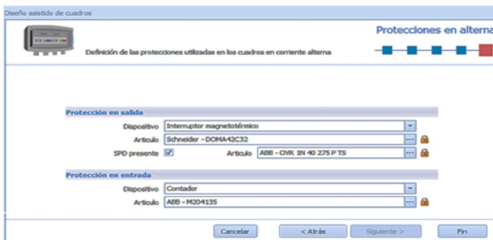
Figura 37. Configuración de protecciones eléctricas.
