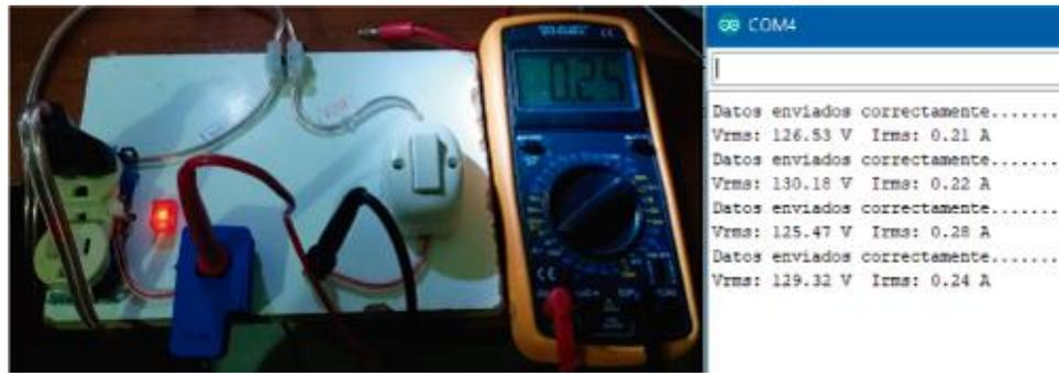
Figura 51. Medición y calibración nivel de corriente.
