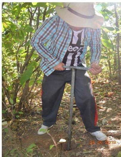
Figura 2. Obtención de muestras de suelo con barreno.
