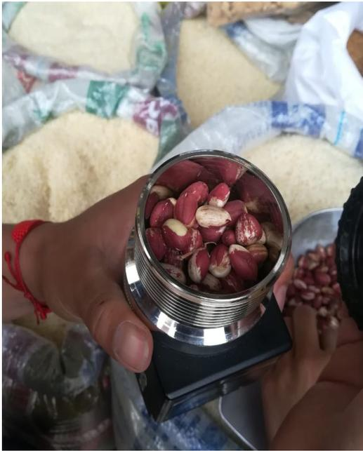
**Figura 11.** Muestra de maní en el medidor humedad
