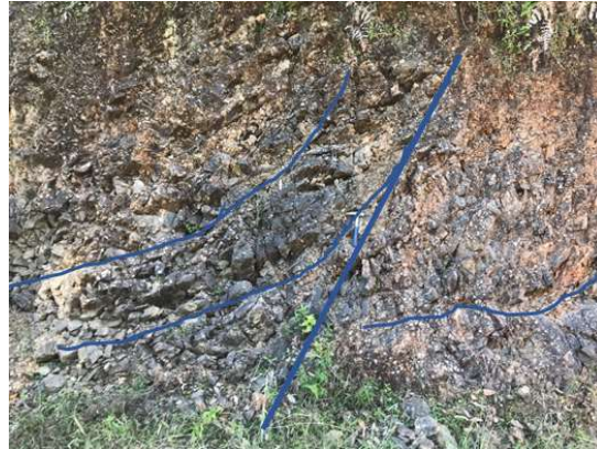
Figura. 33: Tobas volcánicas compactas y presencia de falla normal, sector Piedra Brillante.
