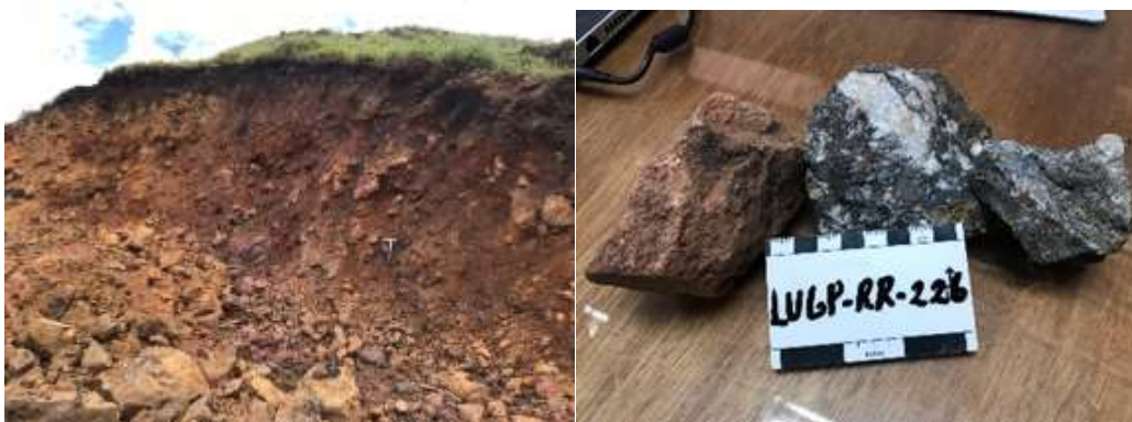
Figura. 28: Afloramiento dentro de la División Melange Palenque de tipo multi composicional entre tobas andesíticas, andesitas basálticas y brechas; sector Artezones, barrio El Palto.
