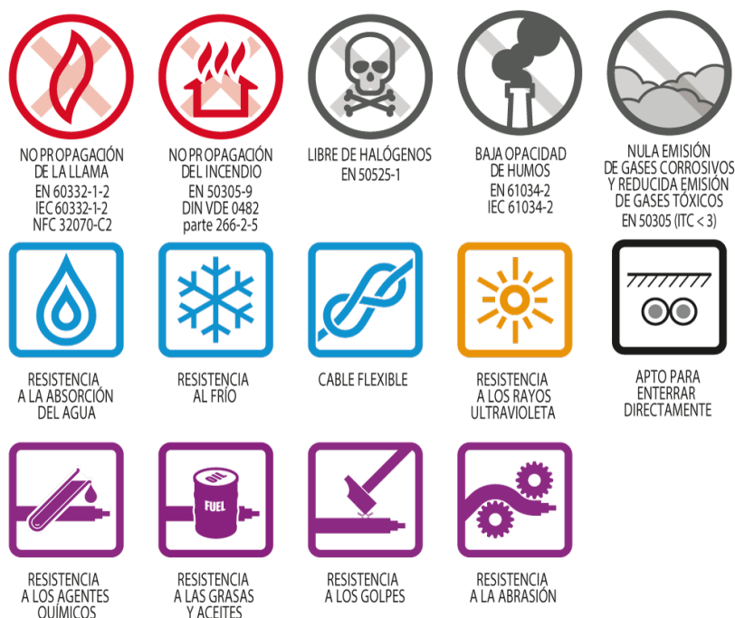
Figura 52: Características generales de conductores para aplicaciones fotovoltaicas. Fuente: Cable solar TECSUN H1Z2Z2-K.
