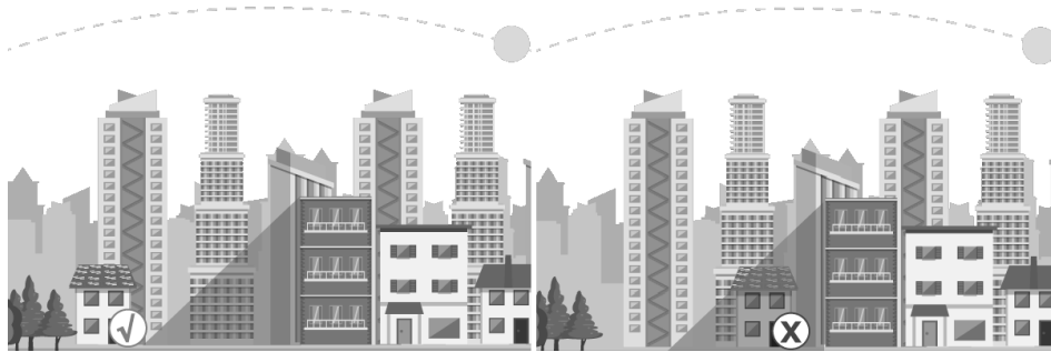
Figura 21: Sombreado generado por edificaciones en entornos urbanos. Fuente: Autor.
