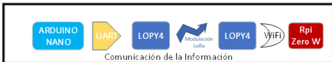
Figura 62. Diagrama simplificado de la comunicación del Sistema en general [Fuente: El autor].
