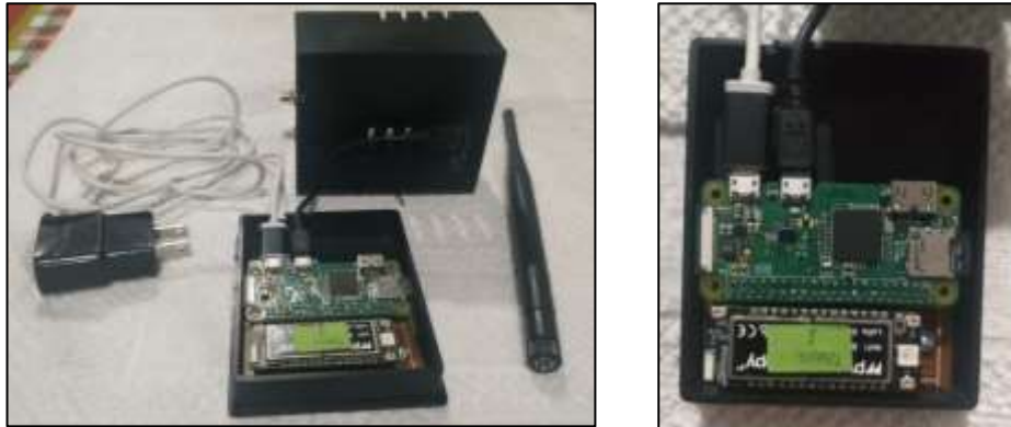
Figura 37. Vistas del Gateway con todos sus elementos montados [Fuente: El autor]
