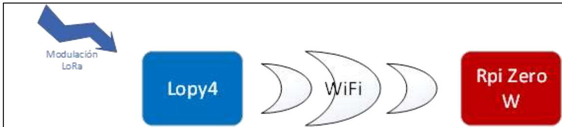
Figura 32. Esquema general del sistema, específicamente en el Gateway del Sistema [Fuente: El autor]
