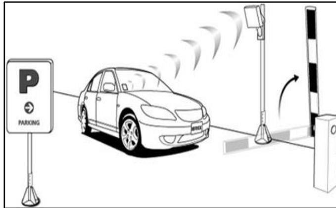
**Figura. 21.** Sistema de control de acceso mediante RFID.
