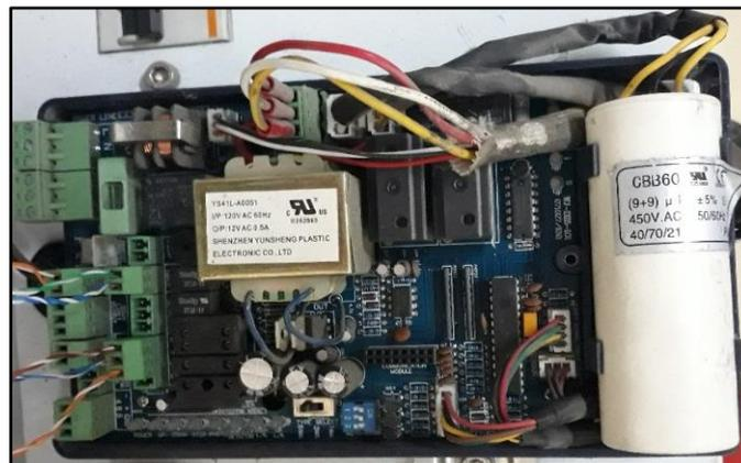
**Figura. 17.** Panel de control de la barrera de acceso.
