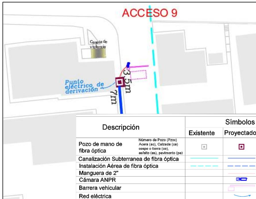
**Figura. 57.** Punto de conexión eléctrico acceso 9 - Carrera de Artes
