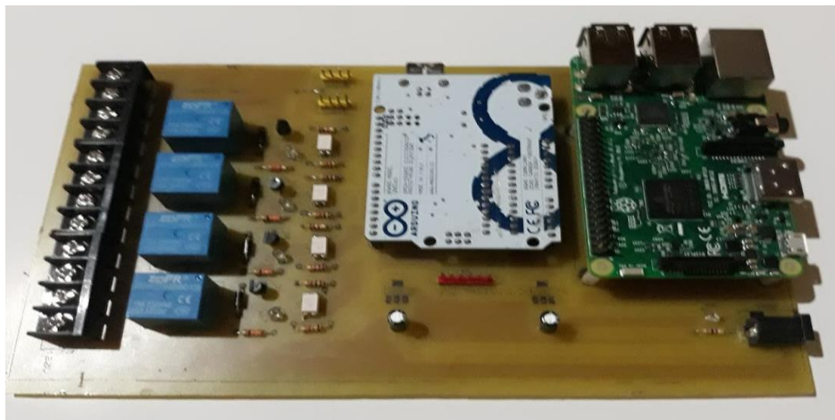
Figura 31 Placa PCB de control del sistema de riego.
