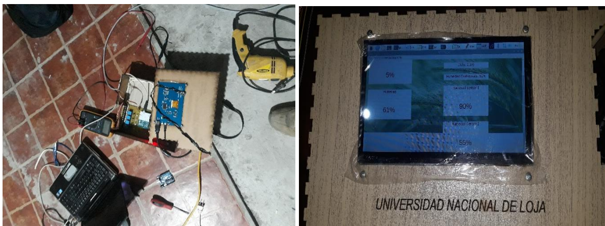
Figura 42 Módulo de Control Sistema de Riego
