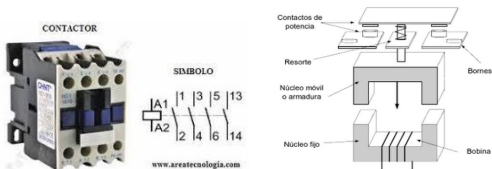
Figura 5 Estructura interna de un Contactor (Daneri, 2008) (atectecnologia, 2008)
