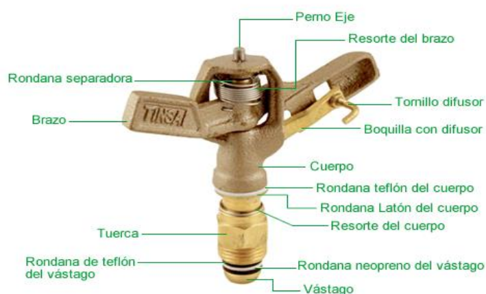
Figura 1 Componentes de un Aspersor (TINSA, 2016)
