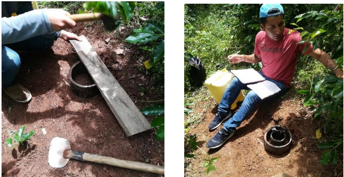
Figura 17. Pruebas de infiltración del agua en suelo
