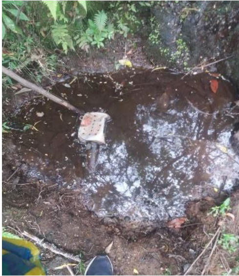
Figura 14. Fuente de agua y medición de caudales (método volumétrico)
