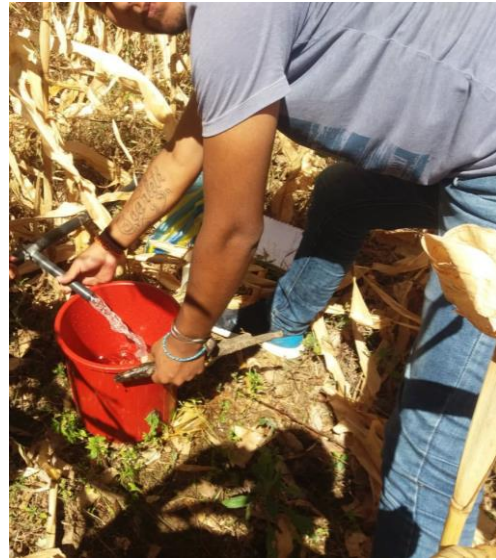
Figura 14. Fuente de agua y medición de caudales (método volumétrico)
