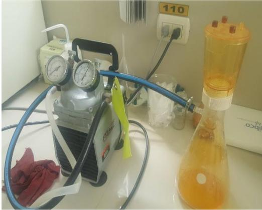
**Figura 23.** Equipo utilizado para la filtración al vacío de muestras digeridas.
