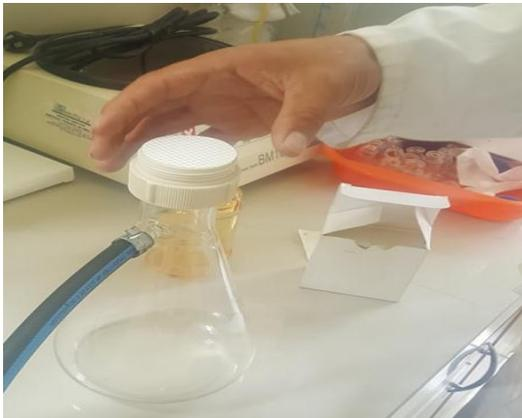
**Figura 25.** Preparación del matraz Elenmeyer para filtración al vacío.
