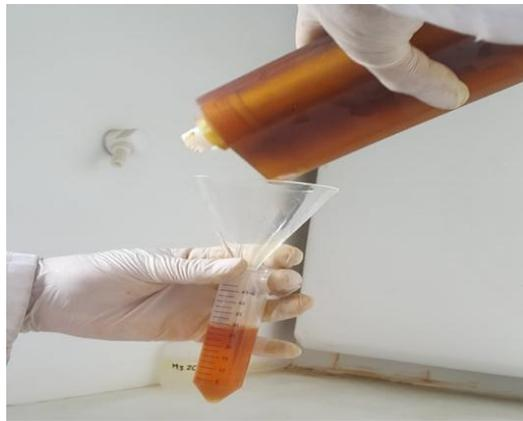
**Figura 22.** Obtención de muestras digeridas para el análisis de contaminantes.
