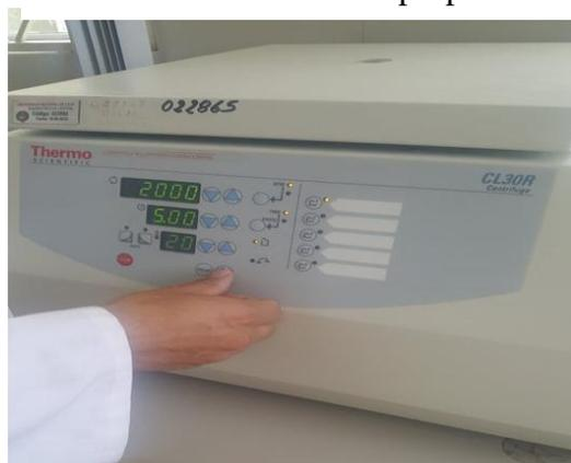
**Figura 28.** Configuración de Parámetros para centrifugación.
