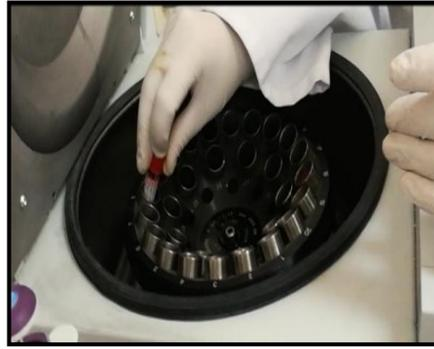
**Figura 8.** Centrifugación las muestras a 3000 rpm durante 5 mnt.
