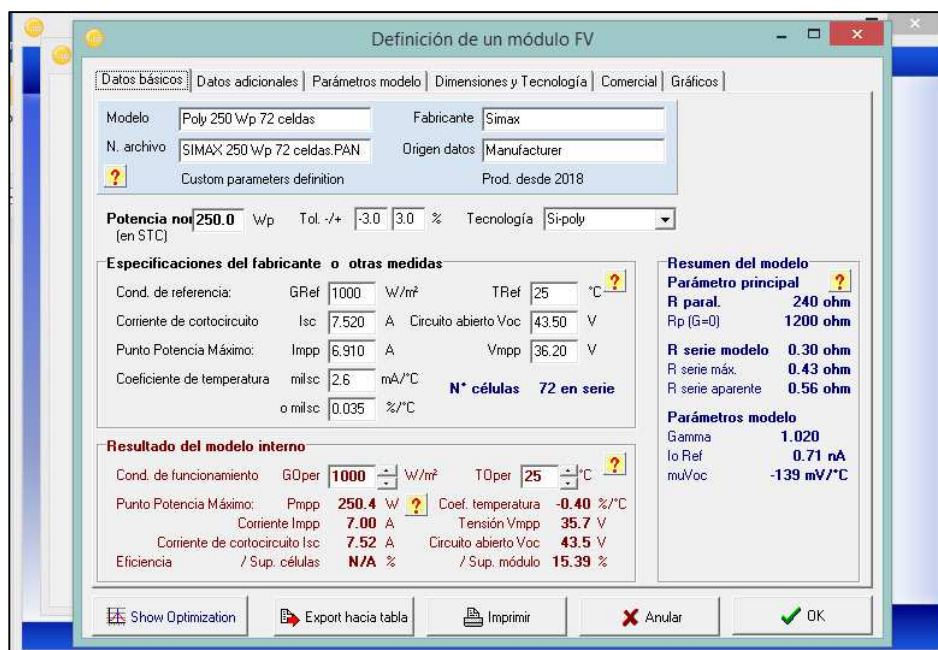
Figura 36. Ingreso de información del panel solar seleccionado. Fuente: Propia del autor.
