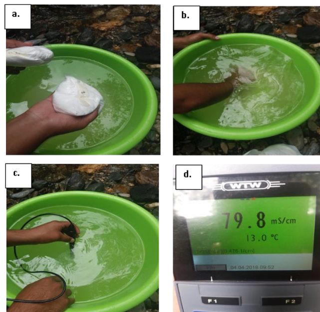
Figura 9. Proceso para medir la conductividad eléctrica del agua. (a) Selección de muestras (b) mezcla (c) medición y (d) resultado de conductividad.
