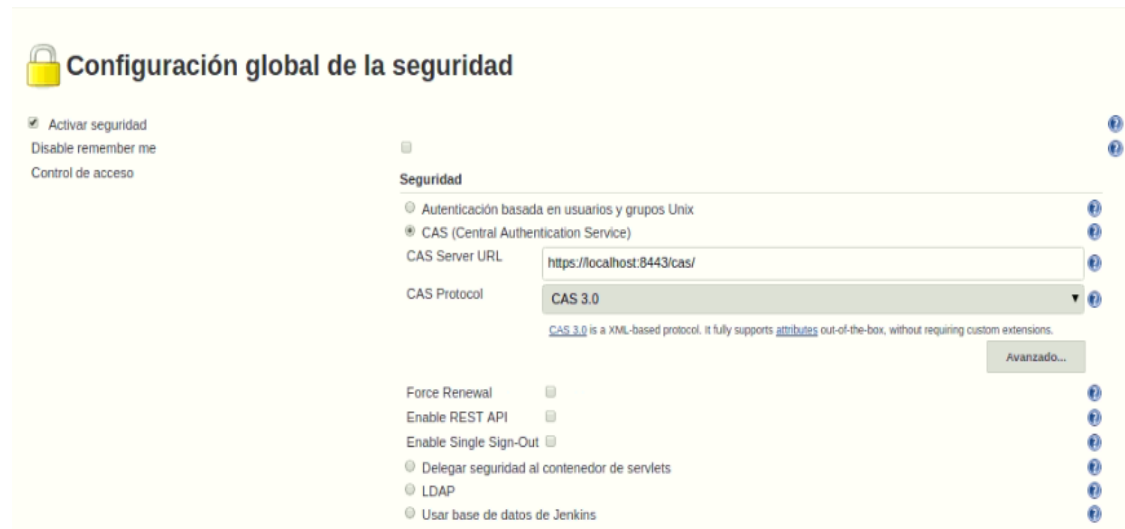
Figura A21. 6. Ruta del servicio CAS para el inicio de sesión en Jenkins
