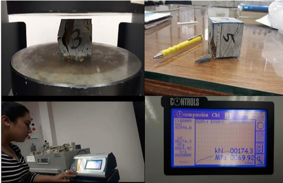
Fotografía 10. Procedimiento del ensayo RCS. Fuente. La Autora, 2019.
