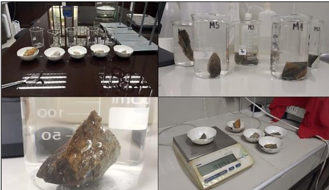
Fotografía 7. Ensayos físicos (porosidad y peso volumétrico) en el laboratorio de Química – UNL. Fuente. La Autora, 2019.
