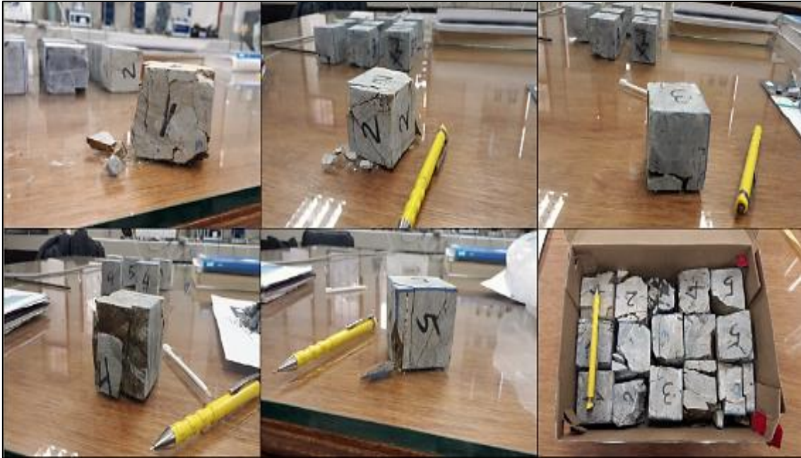
Fotografía 9. Ensayo de compresión simple en cubos de roca– UNL. Fuente. La Autora, 2019.
