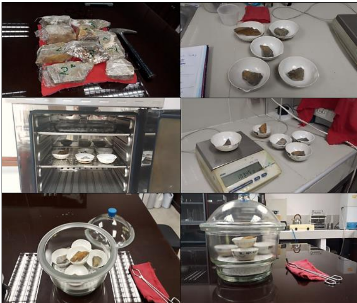
Fotografía 6. Ensayos físicos (contenido de humedad). Fuente. La Autora, 2019.
