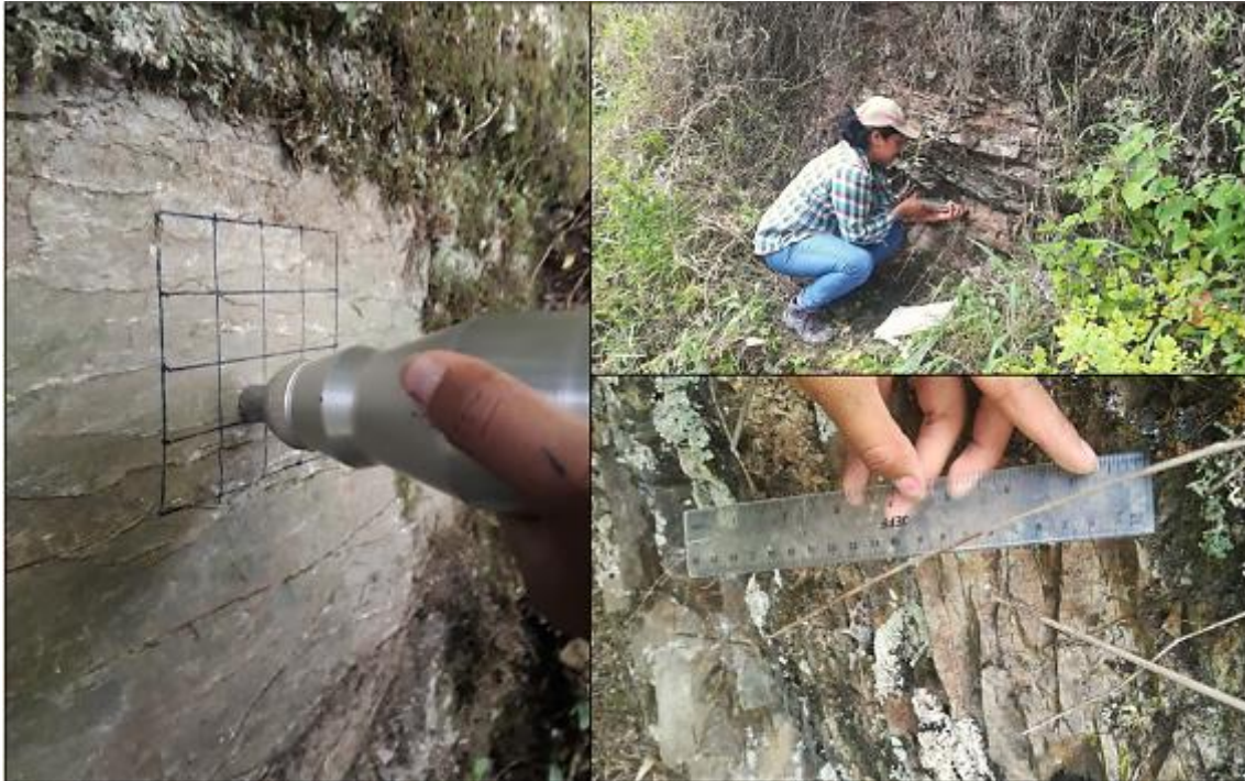
Fotografía 3. Levantamiento "in - situ" de los Macizos Rocosos. Fuente. La Autora, 2019.
