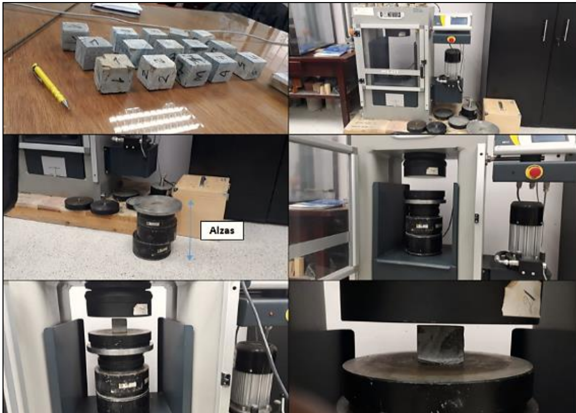
Fotografía 8. Ensayos mecánicos (resistencia a compresión simple). Fuente. La Autora, 2019.
