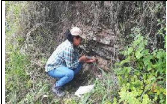
Fotografía N° 7. Aplicación del martillo Schimth para la determinación de la RCS.
