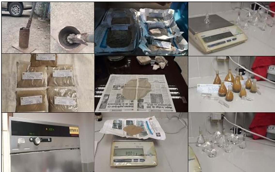
Fotografía 5. Ensayos físicos (densidades). Fuente. La Autora, 2019.
