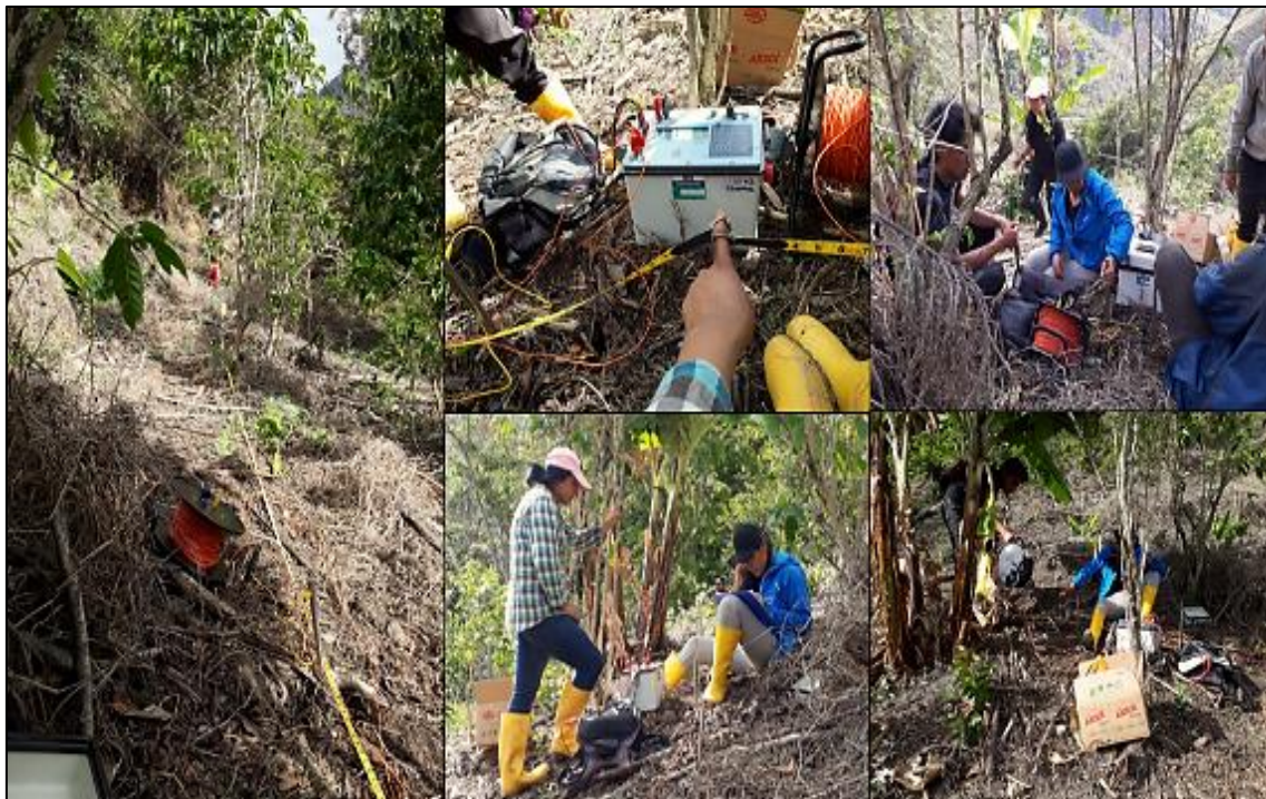
Fotografía 4. Procedimiento del ensayo SEV en el tramo II. Fuente. La Autora, 2019.
