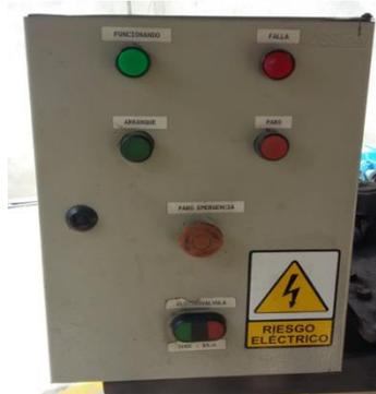
*Imagen E.13. Botonera para el accionamiento eléctrico de la prensa hidráulica*
