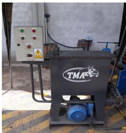
*Imagen E.10. Motor conectado al sistema olio hidráulico*
