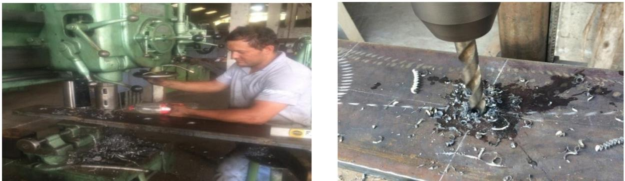
*Imagen E.4. Elaboración de orificios de columnas*
