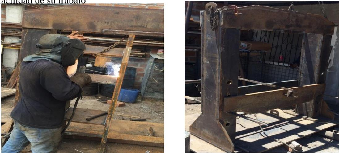
*Imagen E.6. Construcción del faldón inferior*
