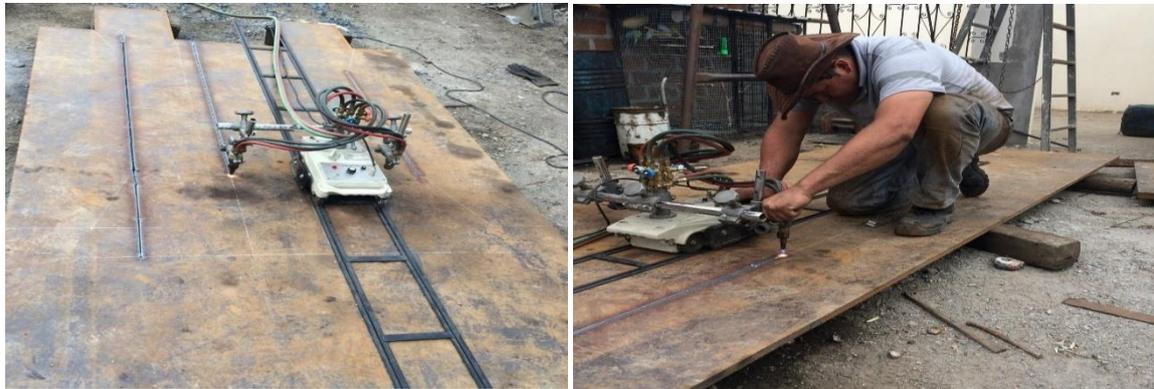
*Imagen E.3. Corte de piezas con el pantógrafo*
