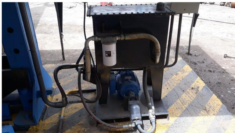
*Imagen E.8. Construcción del sistema oleo hidráulico*
