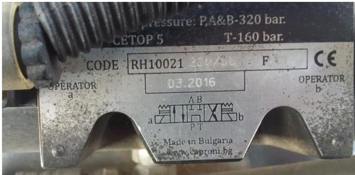
*Imagen E. 1. Distribuidor hidráulico 4/3*
