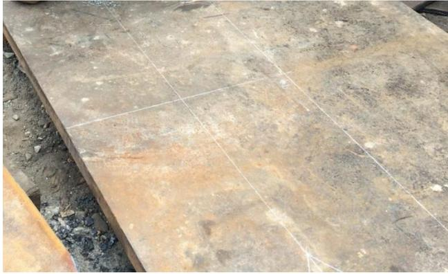
*Imagen E.2. Medición y trazado de medidas en plancha de acero A36 de 20 mm de espesor*
