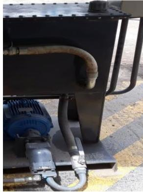
*Imagen E.9. Acoplamiento del tanque reservorio con la bomba hidráulica*
