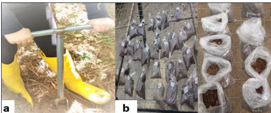
Figura 6. Proceso de obtención de muestras de suelo: a) Uso de barreno; b) Etiquetado de muestras
