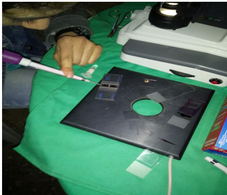
Figura 18. Uso de cámara de Neubauer para la concentración
