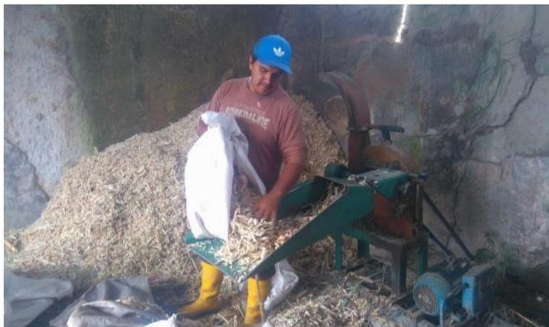
**Foto 1.** Picado del bagazo de caña para proceso de fermentación.
