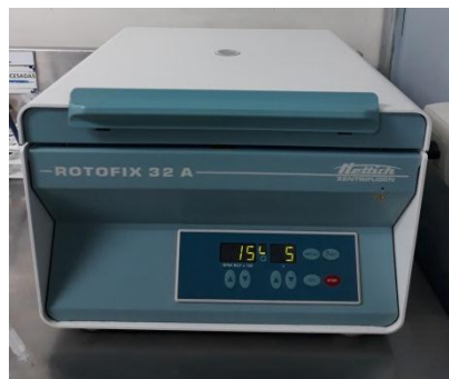
Centrífuga marca Hettich Zentrifugen, modelo Rotofix 32 A de sobremesa
