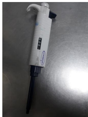
Pipeta graduable (10-100 \mu l) de la marca SPINREACT
