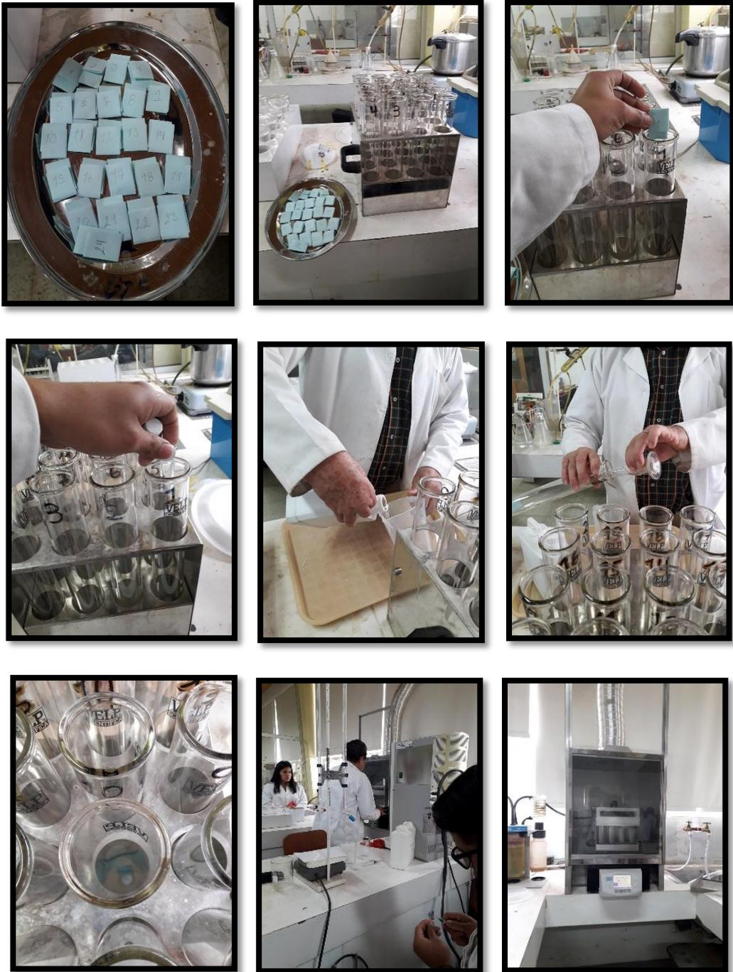
**Figura 10.** Determinación del contenido de proteína cruda.
