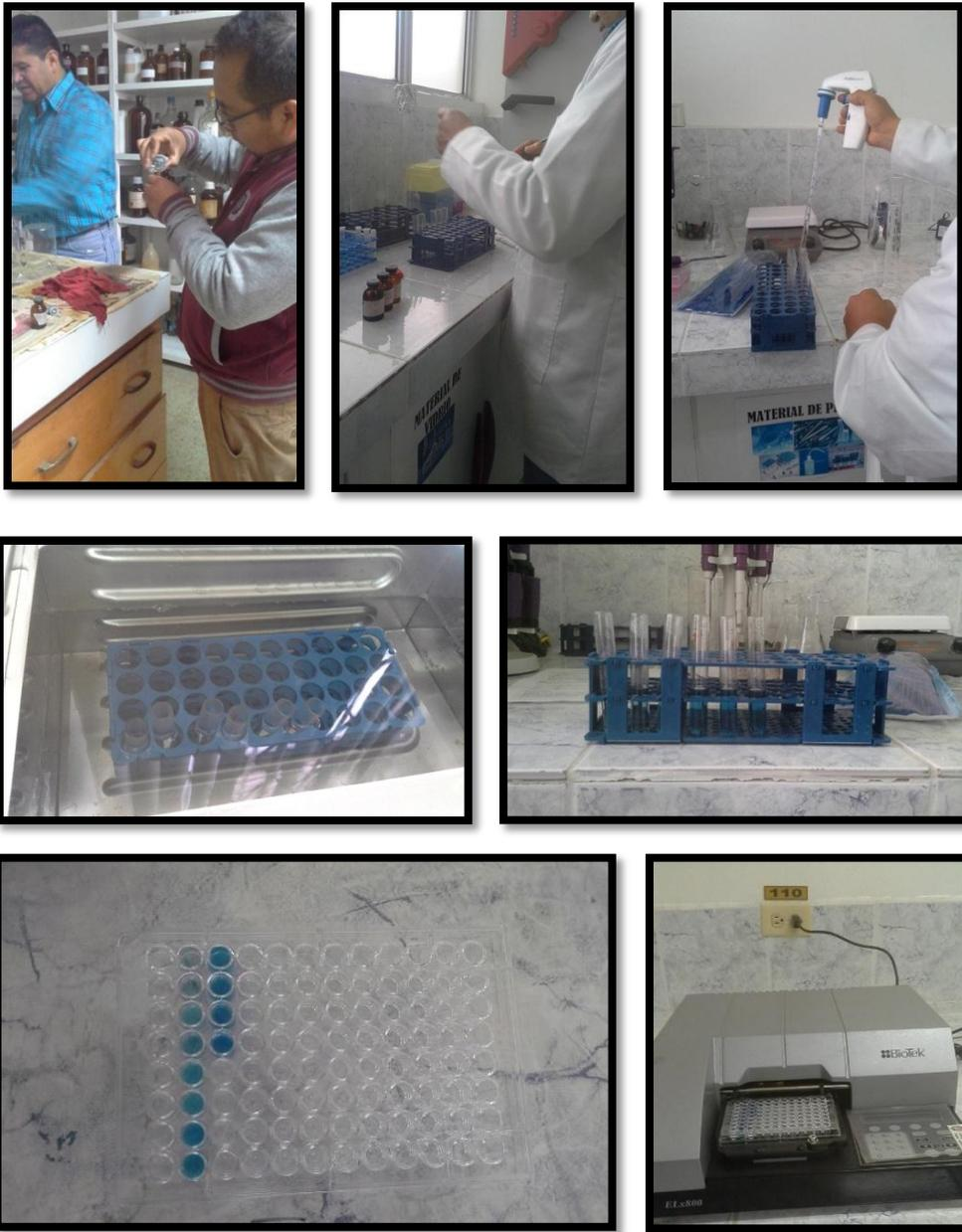
Figura 13. Determinación del contenido de amoníaco.
