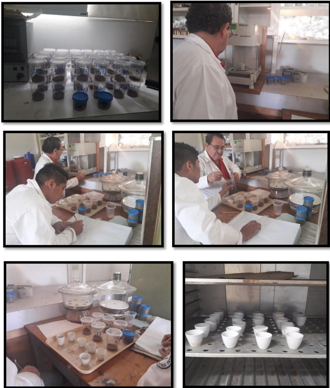
**Figura 8.** Determinación del contenido de humedad higroscópica.
