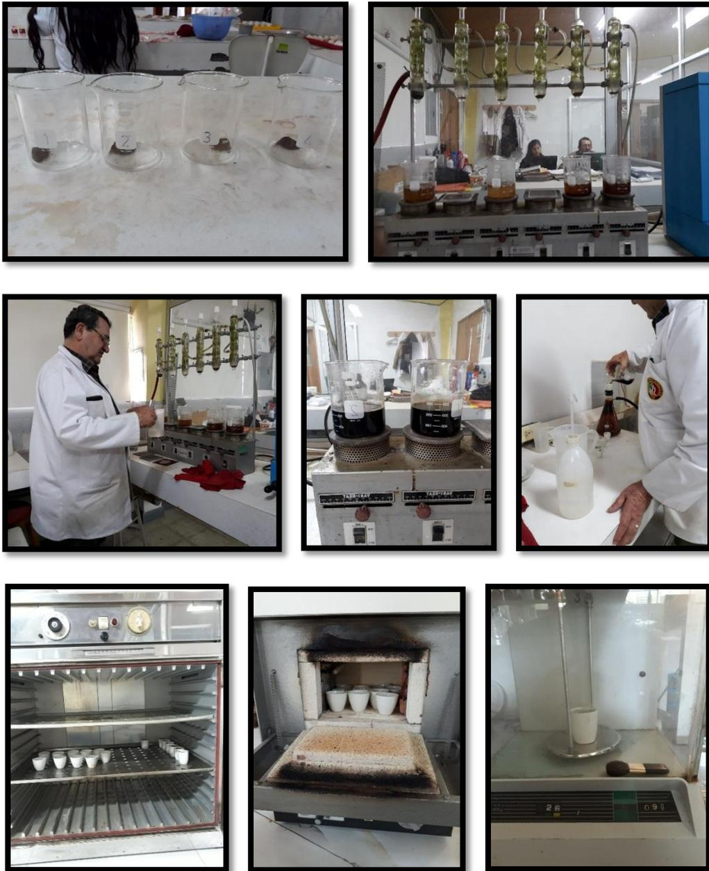
**Figura 11.** Determinación del contenido de fibra cruda.
