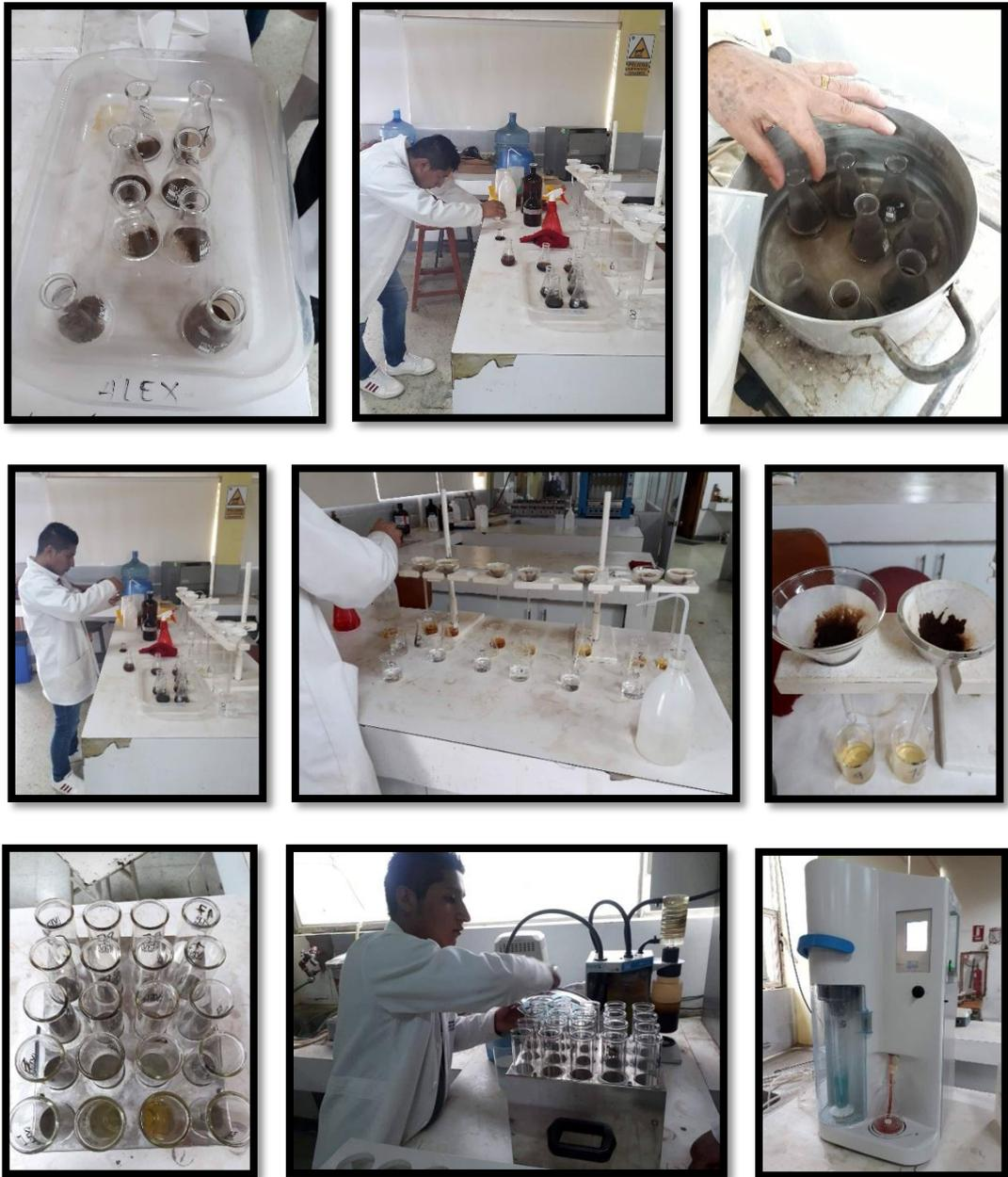
**Figura 12.** Determinación del contenido de proteína verdadera.
