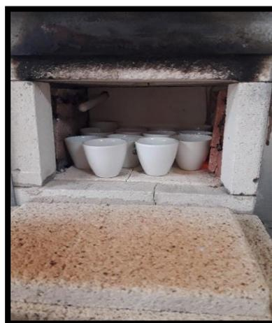
**Figura 9.** Determinación del contenido de cenizas.
