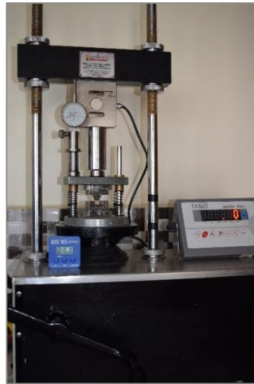
Anexo 8 máquina de ensayos Universal – MARSHALL PS2, adaptada para prueba de flexión en materiales dentales.
