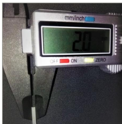
Anexo 4 Calibración de bloques de resina, de acuerdo a la norma ISO 4049.
