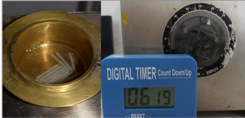
Anexo 5 Termopolimerización GE1 en agua a 60°C durante 60 min..
