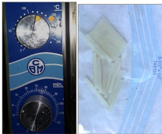
Anexo 6 Termopolimerización del GE2 a 120°C en calor seco durante 10min.
