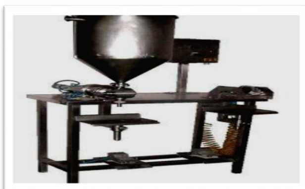
Figura N°12: Dosificadora y selladora
