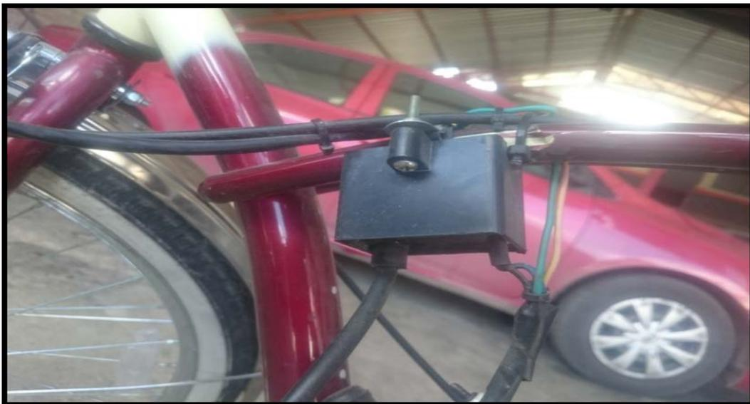
**Figura 79: Instalación bobina de encendido**
