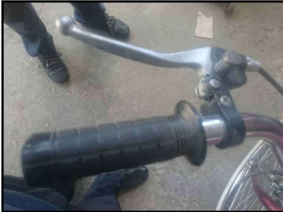
**Figura 70: Instalación mando de embrague**
