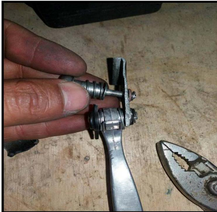
**Figura 74: Corrección del mando de embrague**
