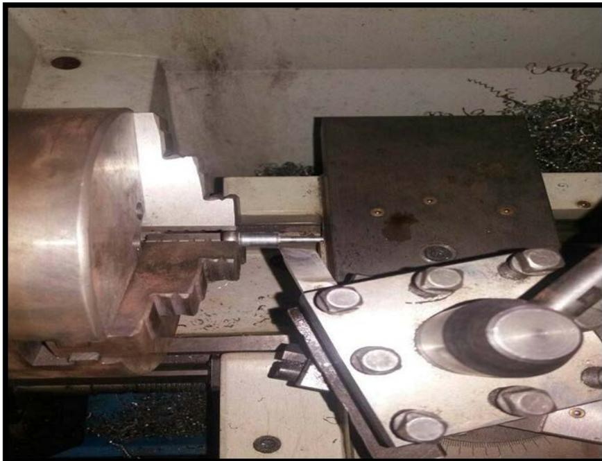
**Figura 65: Fabricación mando de embrague**
