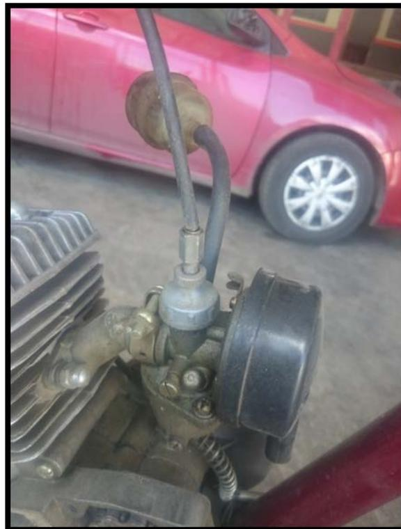
**Figura 81: Calibración del carburador**
