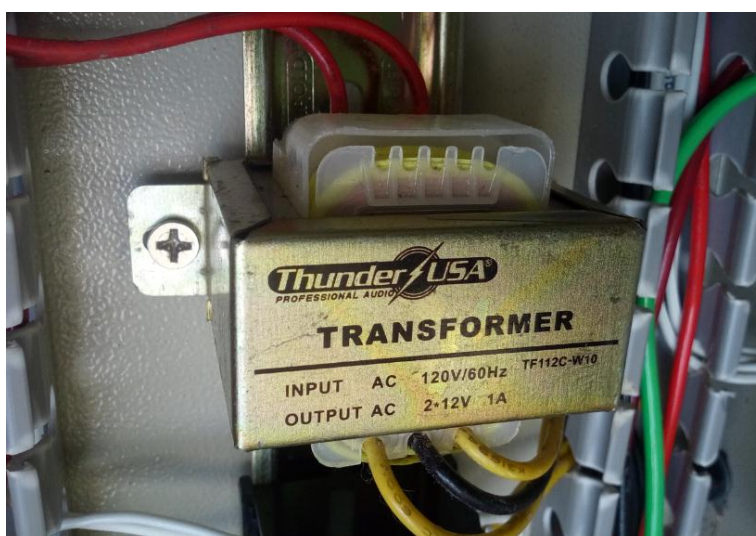
Figura 51: Transformador de 120VAC a 24VAC
