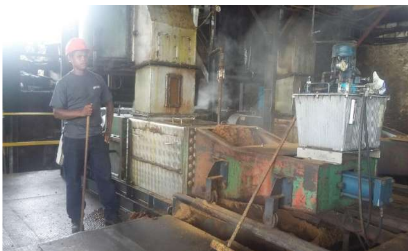
Figura 38. Desfrutador, digestor, prensas. Fuente: Investigación propia (2016). Por: Edgar Sarrias.
