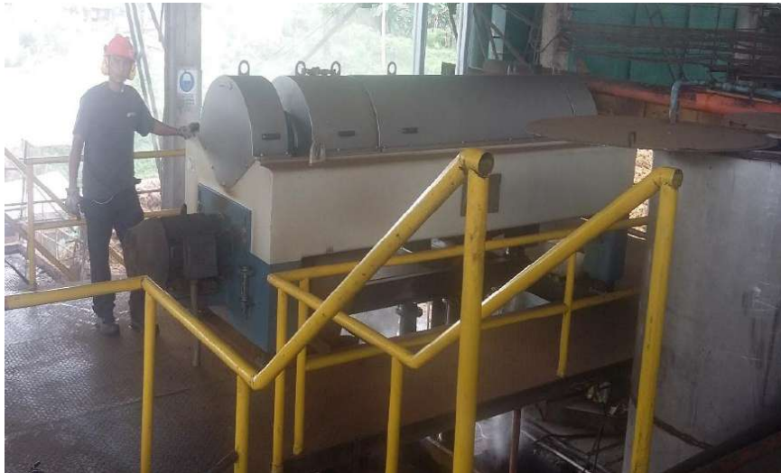
Figura 39. Clarificación dinámica mediante tricanter. Fuente: Investigación propia (2016). Por: Edgar Sarrias.
