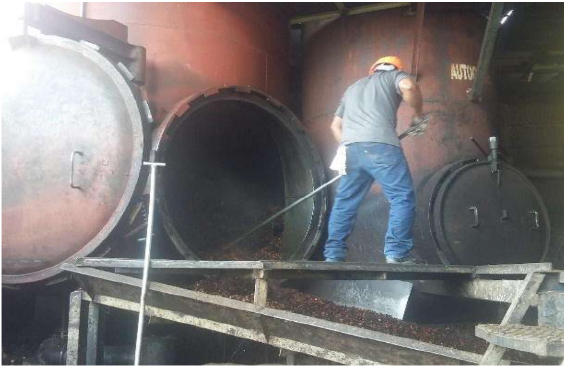
Descarga manual de fruta en los esterilizadores Fuente: Investigación Tomada por: Edgar Sarrias
