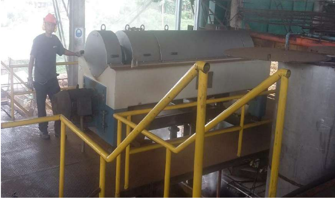
Clarificación por medio del equipo tricanter Fuente: Investigación Tomada por: Edgar Sarrias
