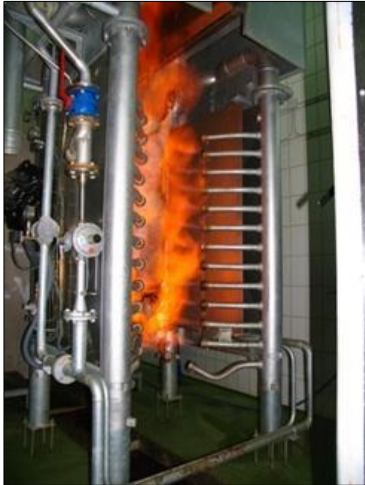
Figura VI. Horno chamuscador mecánova.
