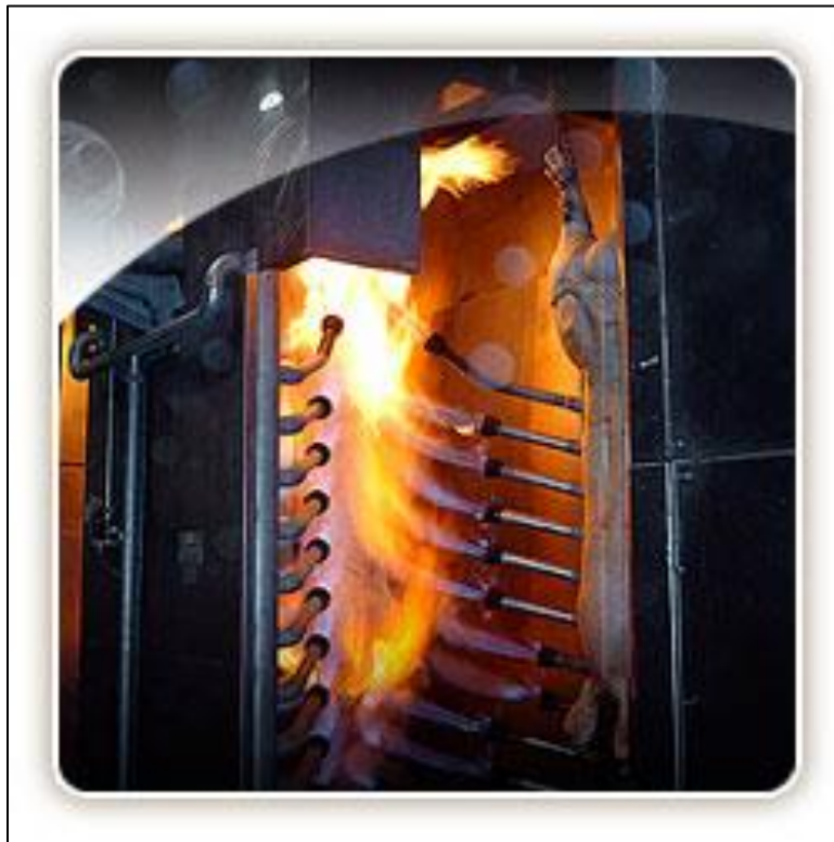
Figura VII. Horno chamuscador CH300.
