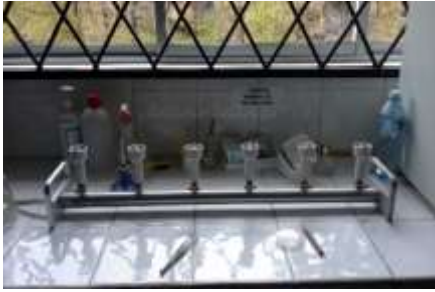
Figura 21. Rampa de Filtración
