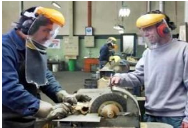
Figura 5: Riesgos mecánicos-Maquinaria desprotegida
