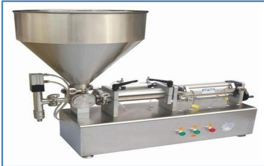
Máquina dosificadora selladora para envasar productos líquidos y pastosos, en fundas prefabricadas o envases rígidos de plástico o vidrio, por sistema volumétrico y que incorpora un conjunto de sellado con mordazas dentadas de temperatura constante.
