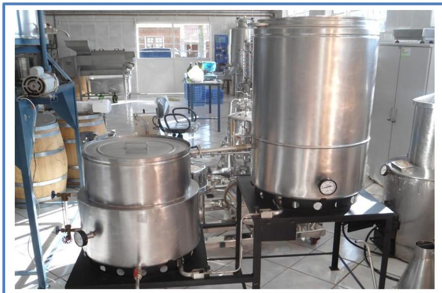
Llamado como tacho dulcero, es equipado con una fuente de calor a gas con regulador de temperatura con capacidad de 67 Kg por cada carga de producción, aspas giratorias accionadas por motor con su control y de accionamiento eléctrico. Su tacho debe ser de acero inoxidable alimenticio.
