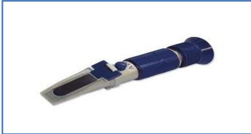
Resistente y de cuerpo de aluminio liviano. Alta calidad y resultados de prueba precisos. ATC rango de compensación (Sistema de compensación automática temperatura incorporado) de 10°C a 30°C. Fácil y muy cómodo de usar. Calibrador sencillo mediante en el mini destornillador.
