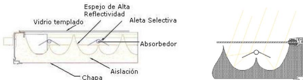
Figura 3. a) Esquema de un colector CPC, b) Marcha de Rayos en un colector tipo CPC (Gentileza AO Sol)
