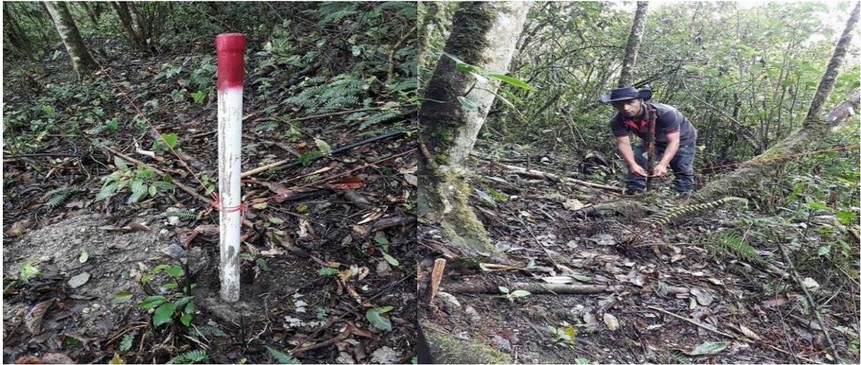
Figura 4. Ubicación del tubo PVC en cada vértice, colocación de jalones y templado de piolas
