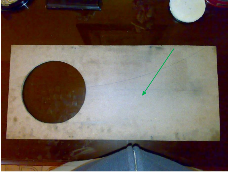
ANEXO Nro.-11 Soporte de madera con orificio para galga extensiométrica.
