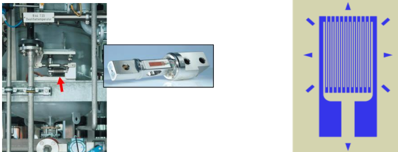
Figura 20. Galga Extensiométrica Piezorresistiva.
