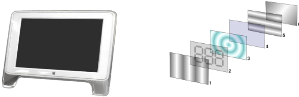
Figura 26. Pantalla de cristal líquido Twisted Nematic (TN).
