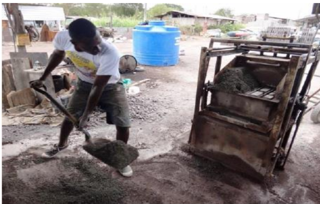
Mezclado de agregado fino con otros componentes para la elaboración de bloques.
