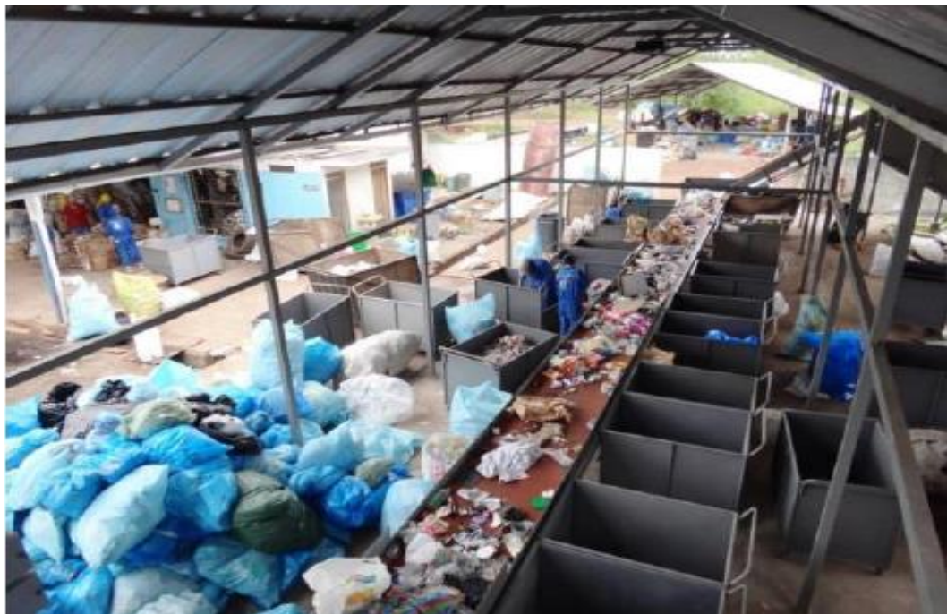
Vista de la banda de separación de los residuos sólidos reciclables.
